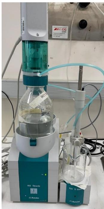
**Figure 3.12: Metrohm 902 Titrande Potentiometric Titrator for endpoint titration**
