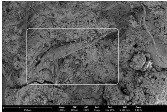
Fig. 8. Fibre without mineralisation (SFKF105).
