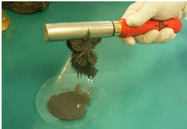
**Figure 2.3:** Magnetic “wand” (Ngeh *et al.*, 2012).
